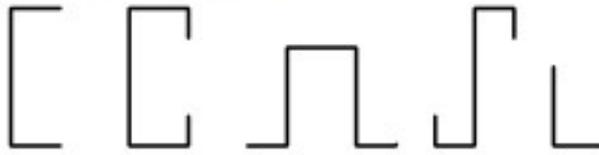
FIGURA 3-Tipo de perfiles y placas conformados
