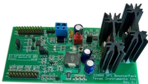
Figura 2. Convertidor Buck "BOOSTXL-BUCKCONV" [2].
