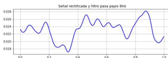
Figura 33: señal rectificada tras el filtro
