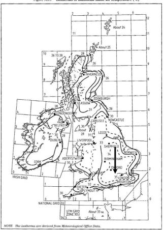
Figura 4.4-7. Mapa con las temperaturas extremas del aire en Reino unido. Fuente: UK National Annex to Eurocode 1. Thermal
