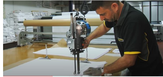
Fig. 145 Operari emprant màquina de tall vertical [180]
