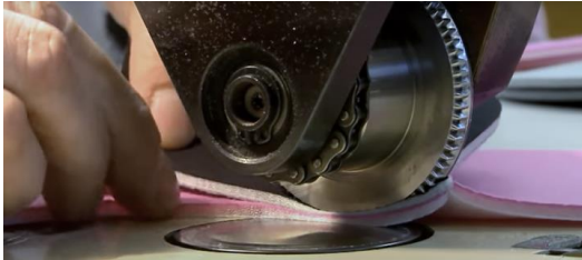
Fig. 159 Detall procediment costura per ultrasons badana [188]
