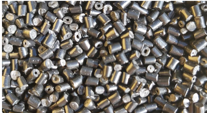
Fig. 131 POM, Polioximetileno o acetal reciclado en forma d'escòria color negre [168]
