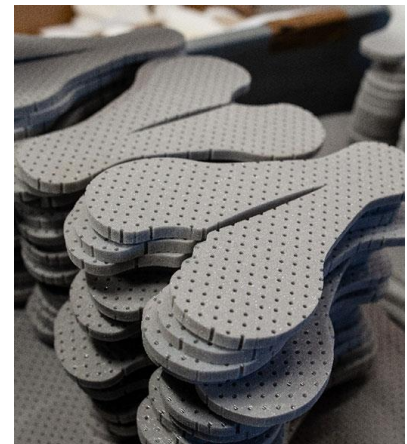
Fig. 152 Espuma tallada amb forma de badana [185]
