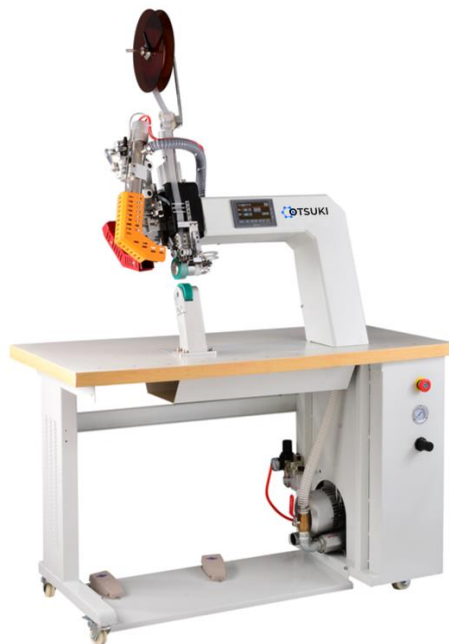
Fig. 161 Termofixadora per a les costures de la badana [190]
