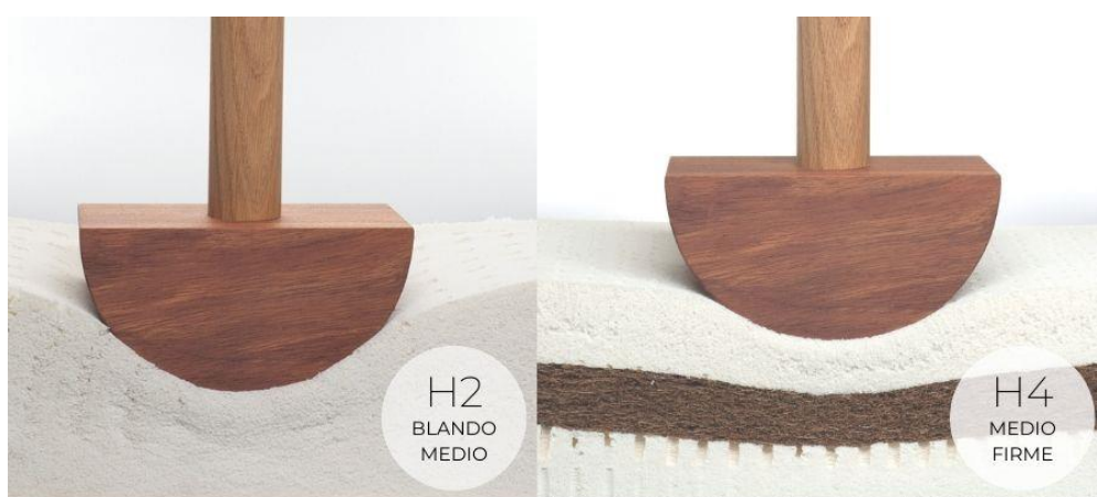
Fig 30. Comparativa de resistència entre el làtex i el reforçat amb fibra de coco [128]
