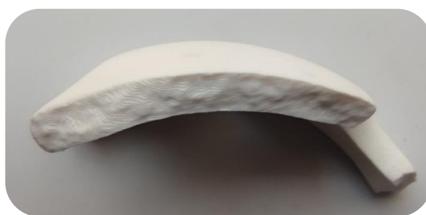
Figura 58. Resolución de la impronta obtenida en la reintegración volumétrica con el material PLA E.P. Fuente propia.
