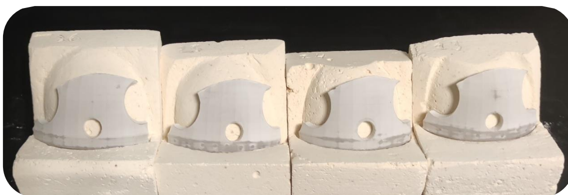
Figura 31. Soportes manufacturados individuales de ladrillo refractario y probetas 4, 5, 6 y 7. Fuente propia.
