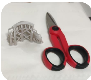
Figura 42. Eliminación de soportes auxiliares. Fuente propia.
