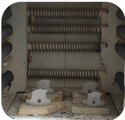
Figura 29. Probetas 2,3,8 y 9-R colocadas sin soportes antes de la cocción. Fuente propia.
