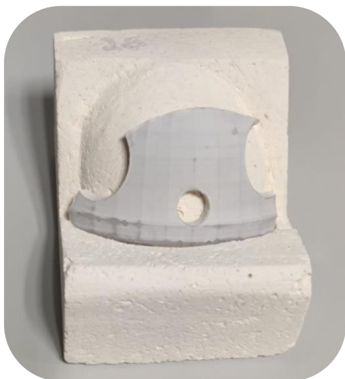
Figura 44. Soporte de ladrillo refractario y pieza antes de la cocción. Fuente propia.
