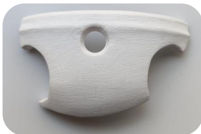
Figura 60. Superficie de la reintegración volumétrica obtenida en pasta cerámica PA. Fuente propia.
