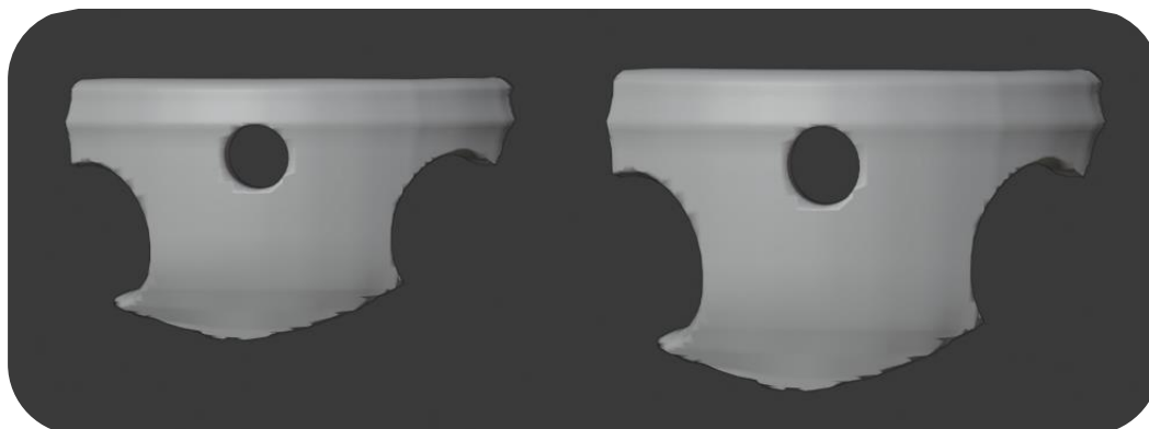
Figura 36. Modelos 3D de la reconstrucción. Izquierda: el modelo original de la reconstrucción; derecha: el modelo deformado de la probeta 7R. Fuente propia.
