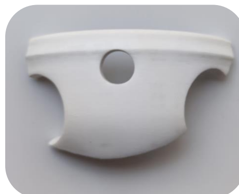
Figura 49. Reintegración volumétrica en PLA E.P. finalizada. Fuente propia.
