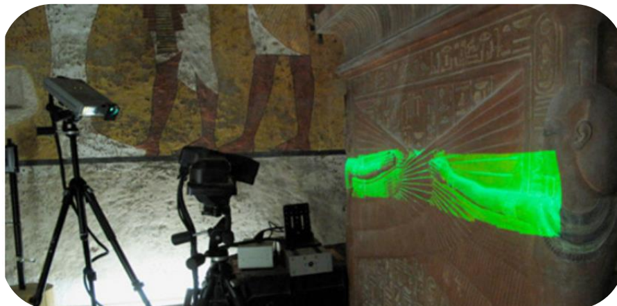
Figura 8. Escaneado mediante luz estructurada en la tumba de Tutankamón. Fuente: FACTUM ARTE 2009.
