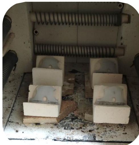
Figura 30. Probetas 4, 5, 6 y 7-R colocadas sobre soportes antes de la cocción. Fuente propia.
