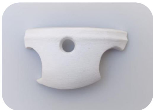
Figura 52. Reintegración volumétrica en pasta cerámica PA tras la cocción. Fuente propia.
