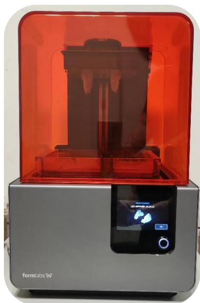
Figura 39. Impresora Form 2 en la ejecución del modelo. Fuente propia.
