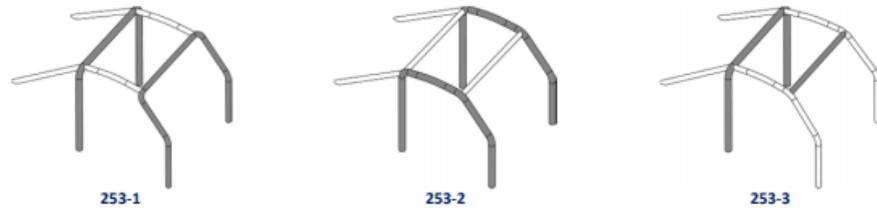
**Ilustración 7: Configuraciones básicas de una jaula según Anexo J**
