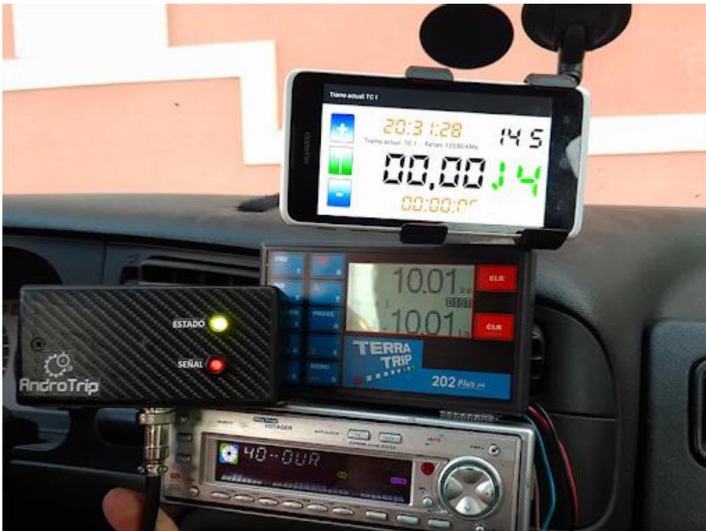
**Ilustración 13: Dispositivo Rallymeter empleado en ralis de regularidad**
