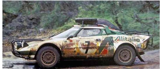
**Ilustración 6: Lancia Stratos con refuerzos exteriores para impactos.**
