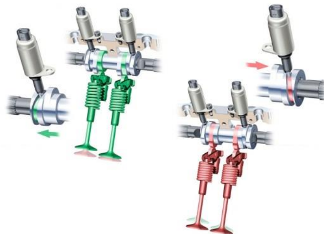
Ilustración 11. Esquema de funcionamiento del sistema Valvelift (11)
