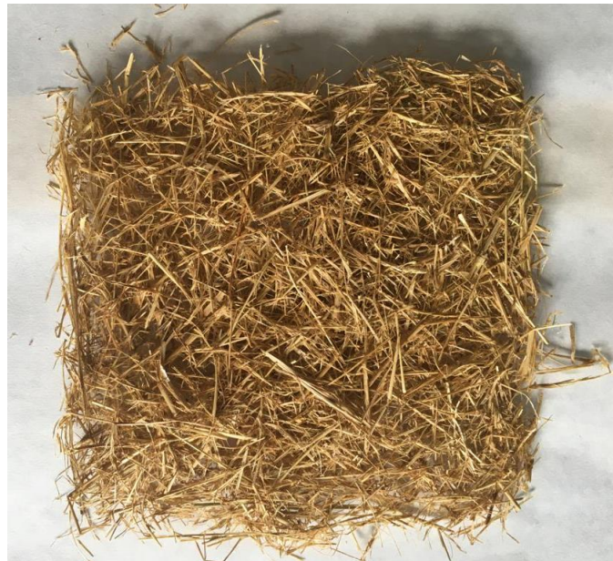
Figura 117 - Tela no tejida con quitosano por capas con fibras cardadas
