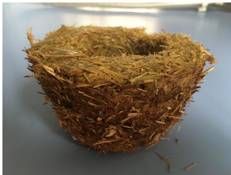
Figura 127 - Muestra 16 - Disolución de agar - agar con fibras molidas forma 3
