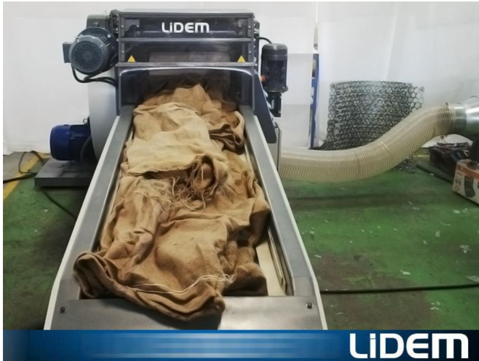
Figura 149 - Cortadora rotativa para el corte y reciclaje de fibras de sisal, cañamo, esparto, coco, ramio, abaca de LIDEM [198].
