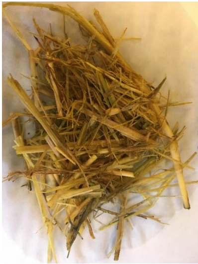
Figura 132 – Fibras no tratadas tintadas con cúrcuma
