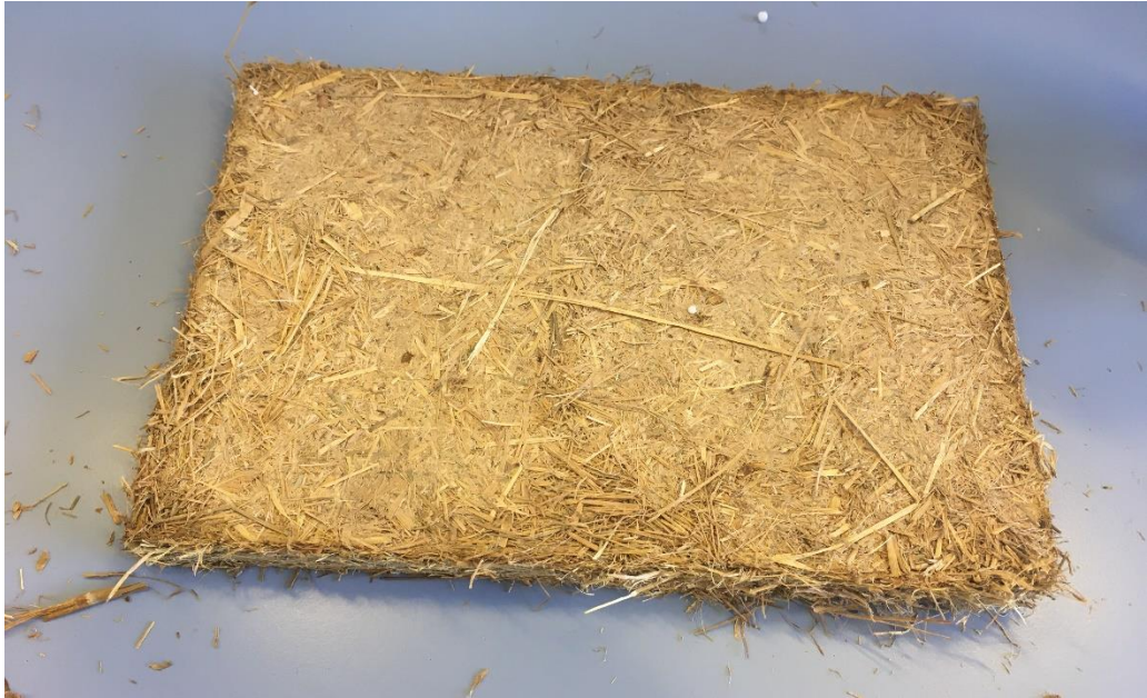
Figura 122 - Muestra 9 - Disolución de agar-agar con fibras molidas y cardadas
