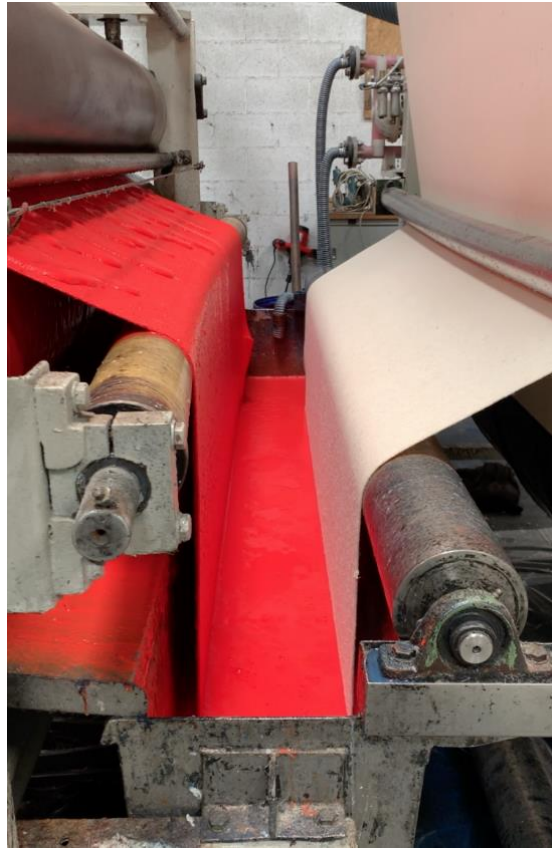
Figura 14 - Aplicación de acabados [34]
