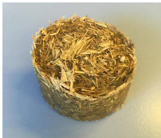
Figura 125 - Muestra 14 - Disolución de agar – agar con fibras molidas 2
