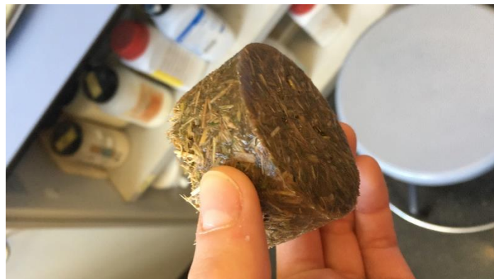
Figura 124 – Muestra 14 - Disolución de agar – agar con fibras molidas 1
