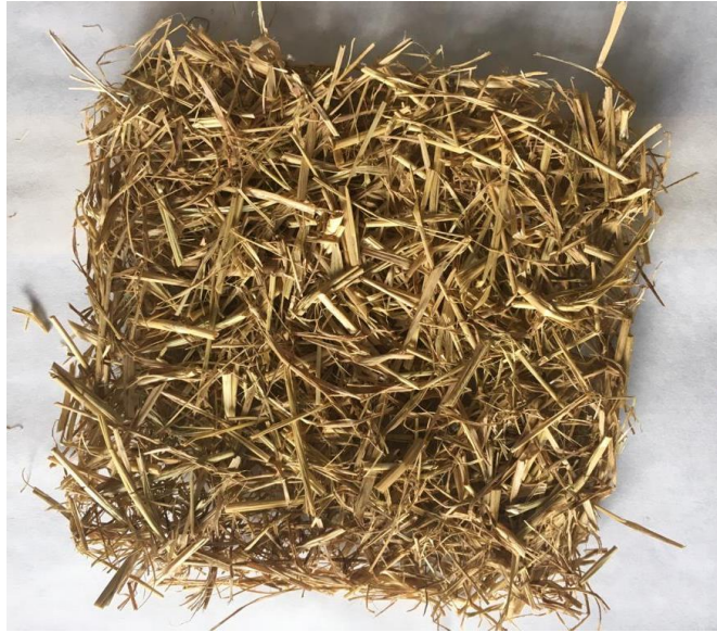
Figura 116 - Tela no tejida con quitosano por capas con fibras de 1 cm de longitud
