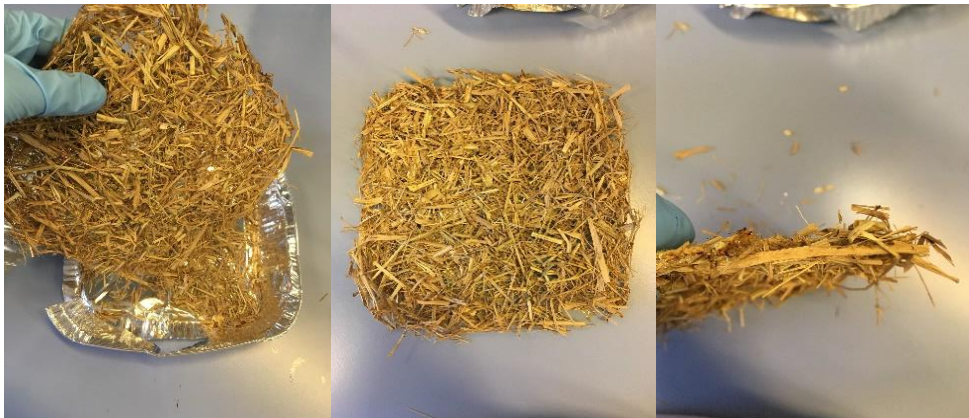
Figura 115 - Tela no tejida con quitosano con fibras de 1 cm de longitud
