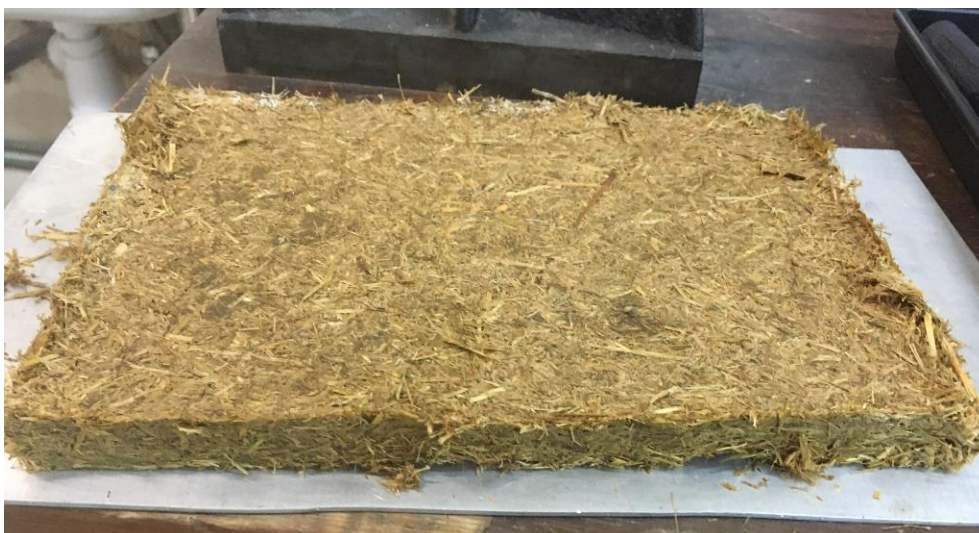
Figura 119 - Muestra 6 - Disolución de maicena con fibras molidas
