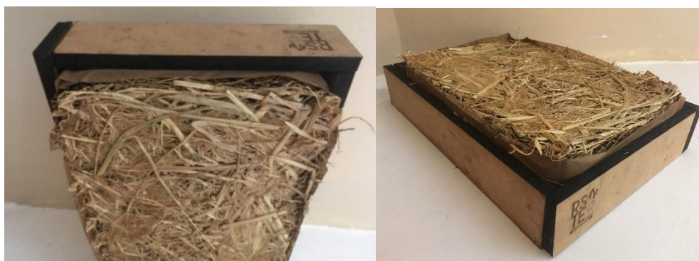
Figura 141 - PRODUCTO FINAL 1: Sustrato para jardines verticales, fachadas verdes o cultivos hidropónicos
