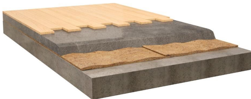
Figura 29 -Esquema del funcionamiento de aislamiento de suelos con no tejido de fibras de coco [90]
