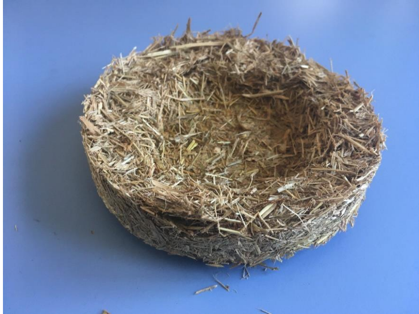
Figura 126 – Muestra 15- Disolución de agar – agar con fibras molidas forma 2
