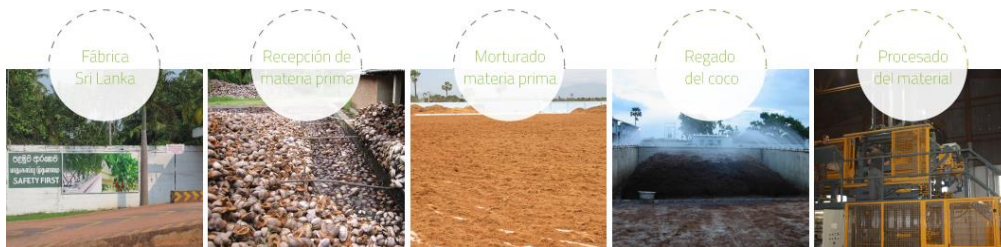
Figura 37 - Proceso de fabricación de los sustratos a partir de fibra de coco [106]
