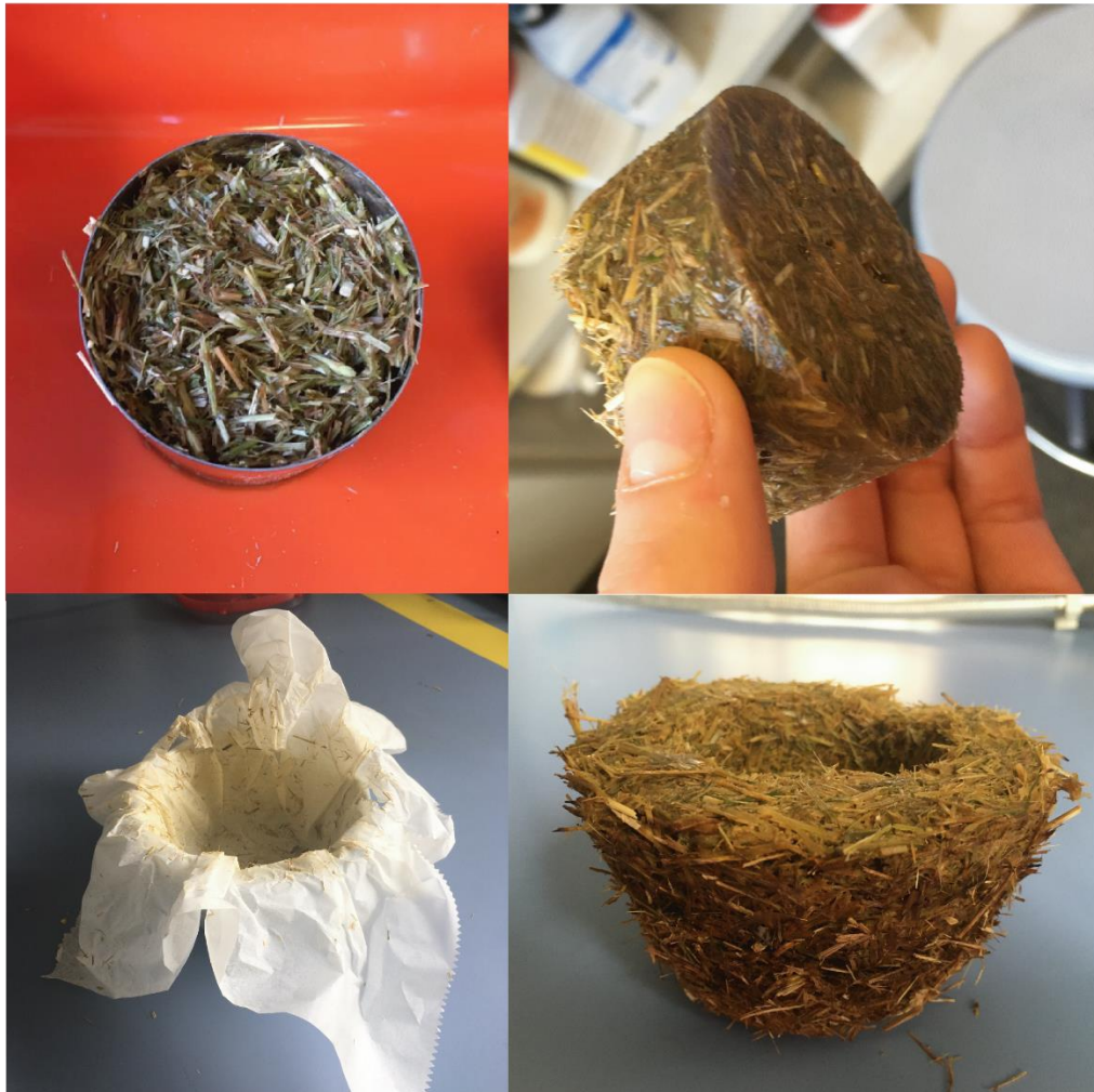
Figura 108 – Proceso de conformado y desmoldeo de los no tejidos con forma tronco-cónica
