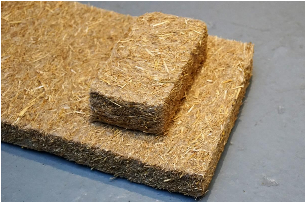
Figura 42 - Paneles de paja de arroz para uso en la construcción con aislante en paredes. YES Innovation [117]
