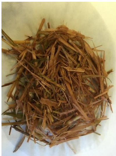
Figura 130 - Fibras no tratadas tintadas con rubia tintórea
