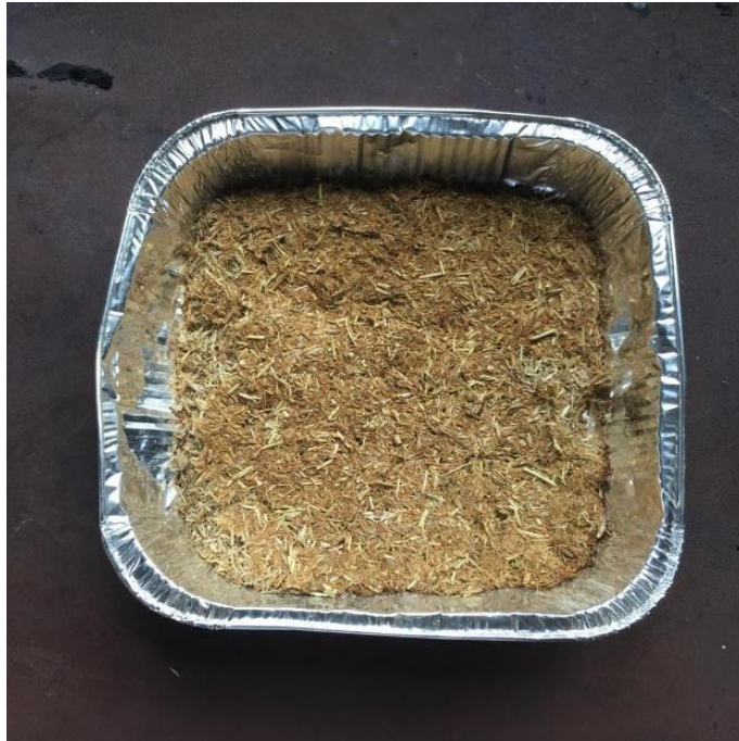
Figura 118 - Tela no tejida con quitosano por capas - fibras molidas
