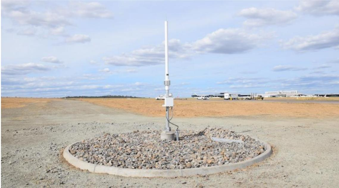
*Figura 5. Antena RRA GBAS del Aeropuerto de Melbourne (Obtenido de [australianaviation.com](http://australianaviation.com))*
