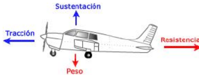
Figura 3.7: Fuerzas que actúan durante el vuelo de un avión (dominio público).
