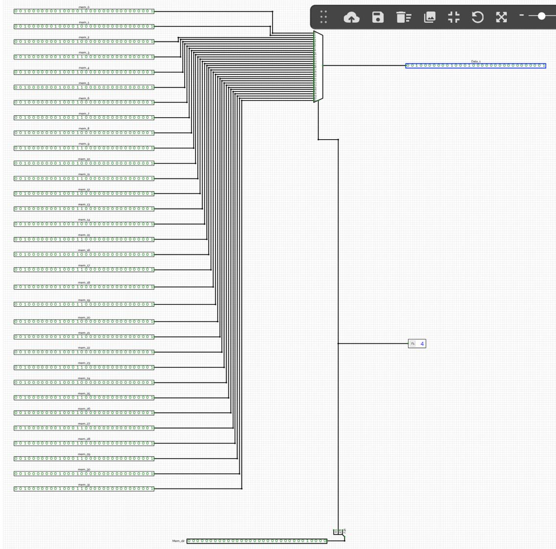
**Figura 4.11:** Implementación en CircuitVerse de la memoria de instrucciones. Teniendo esta 32 posiciones de memoria estando cada posición de memoria en una dirección múltiplo de cuatro. La memoria de instrucciones en la figura contiene varias instrucciones *addi* utilizadas para una prueba de la ruta de datos.
