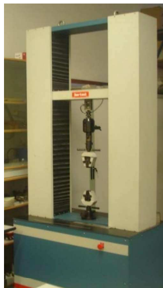
Figura 55. Máquina universal de ensayos del laboratorio de ensayos destructivos.
