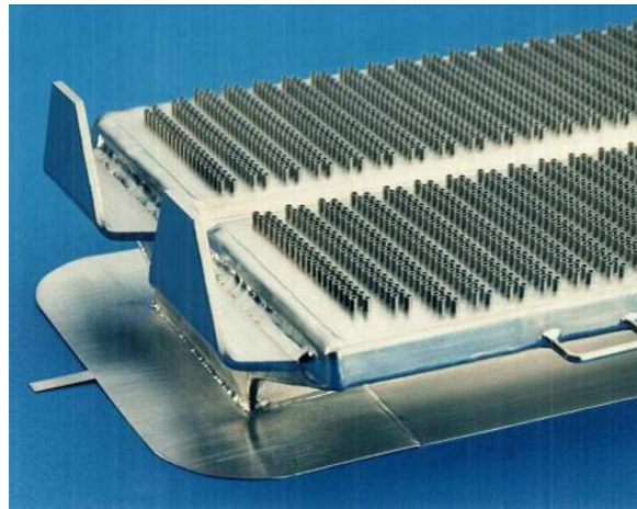
Figura 11. Bushing por el que pasa el material refundido.
