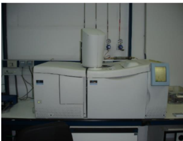
Figura 7. Fotografia de cromatògraf de gasos i un detector de masses Clarus 500 GC-MS
