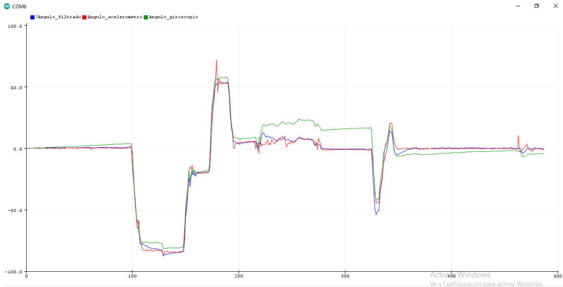
Figura 37: Medidas individuales y filtrada del MPU-6050 para K = 0.9
