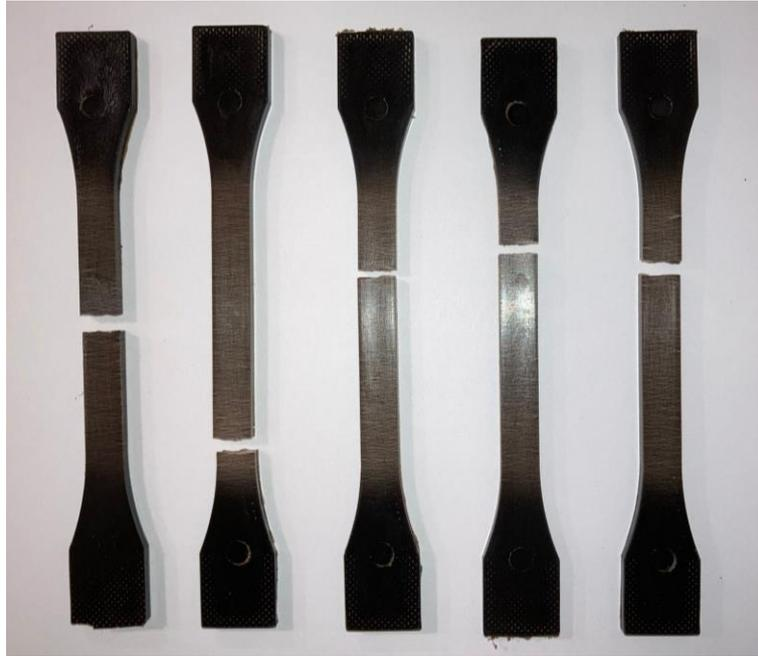
Figura 16: probetas de PLA+SCG+OLA2mal tras el ensayo de tracción
