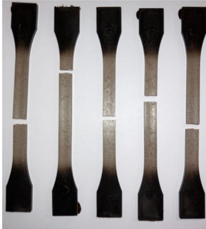
Figura 14: probetas de PLA+SCG tras el ensayo de tracción
