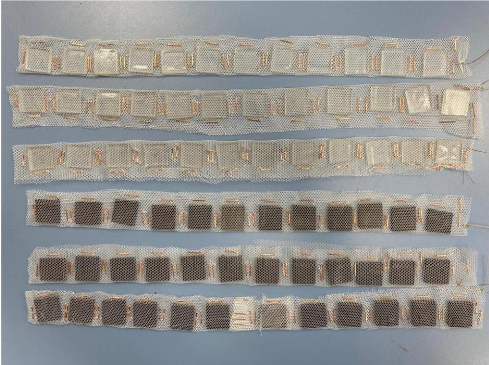
*Figura 10: preparación de muestras para el ensayo de biodegradación*
