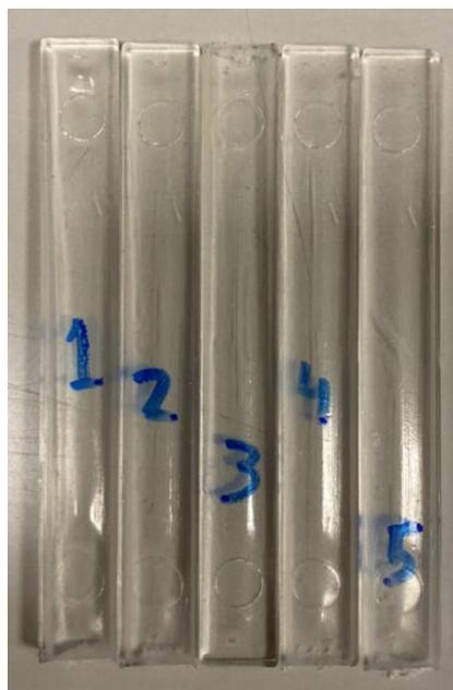
Figura 8: probetas para ensayo Charpy
