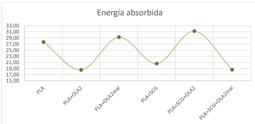
Figura 21: gráfica de la absorción de energía en el ensayo Charpy
