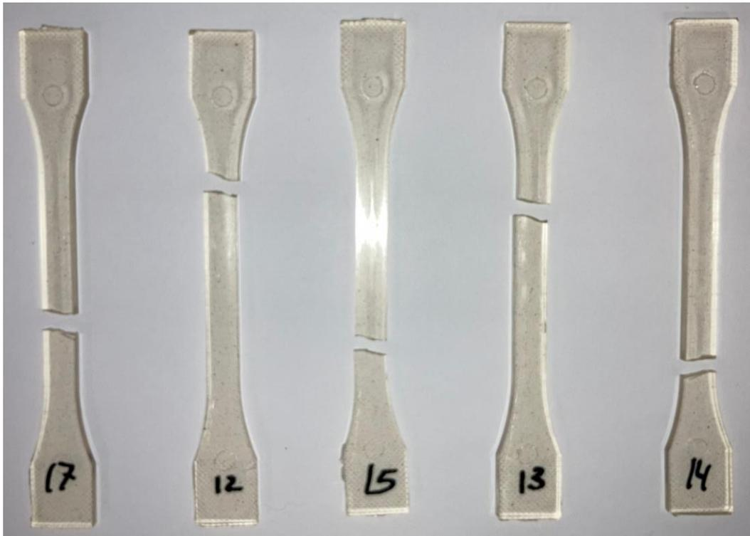
Figura 13: probetas de PLA+OLA2mal tras el ensayo de tracción
