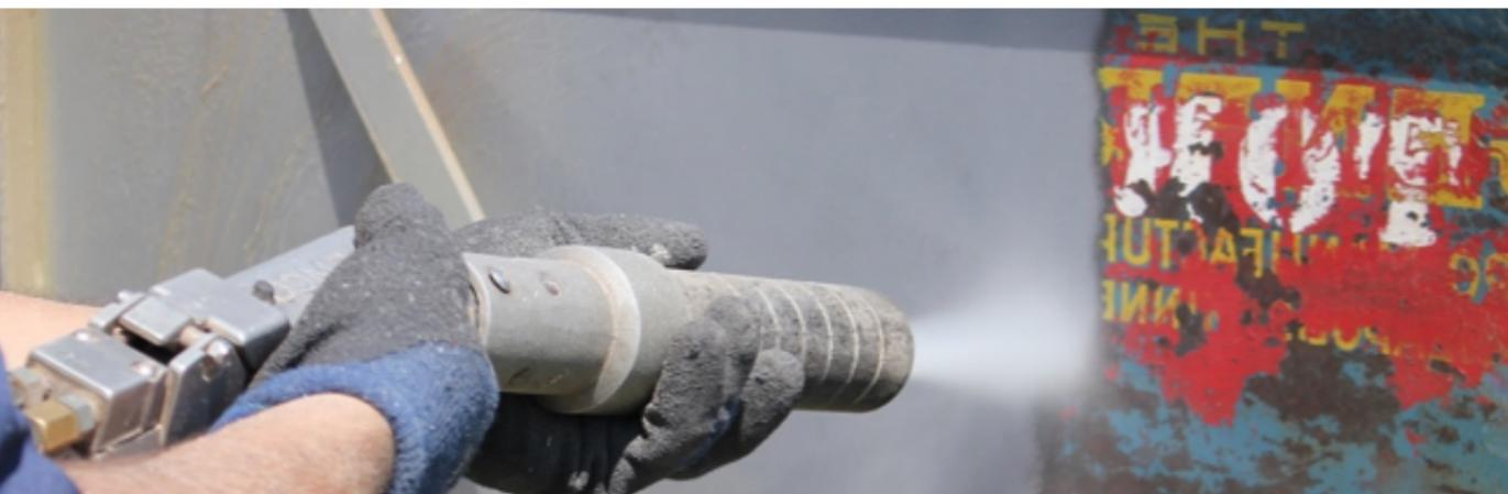
Fig. 15 Proyección de CO<sub>2</sub> sobre una superficie esmaltada. Fuente: RM Contractors, 2020.
