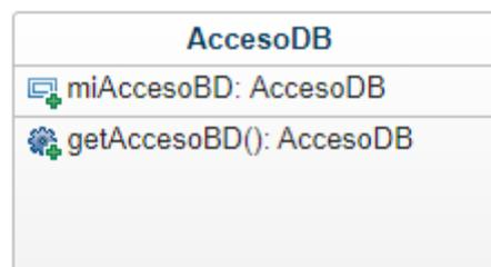
Figura 13: diagrama UML del patrón singleton
