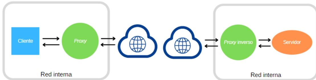
**Figura 1.1:** Esquema de un *proxy* frente a un *proxy* inverso.
