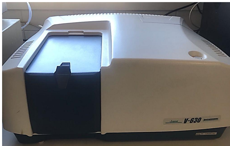
Figura 10. Fotografía del espectrofotómetro de absorción UV-vis utilizado durante el trabajo.
