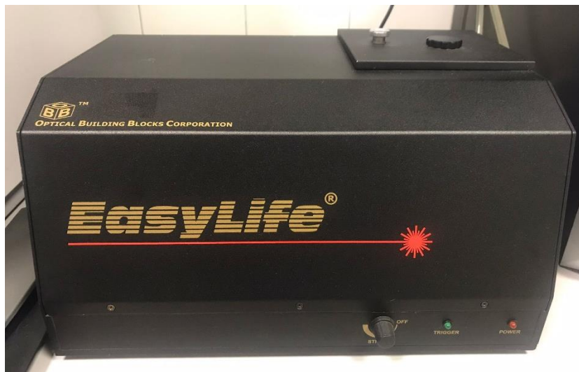
Figura 12. Fotografía del espectrofluorímetro de resolución temporal utilizado en el trabajo.
