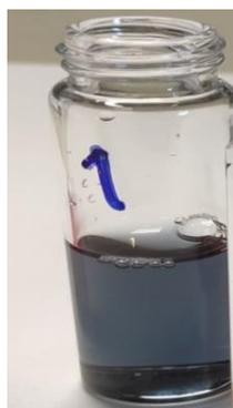
**FIGURA 17. Disolución de AuNRs después de lavar repetidas veces y filtrar.**
