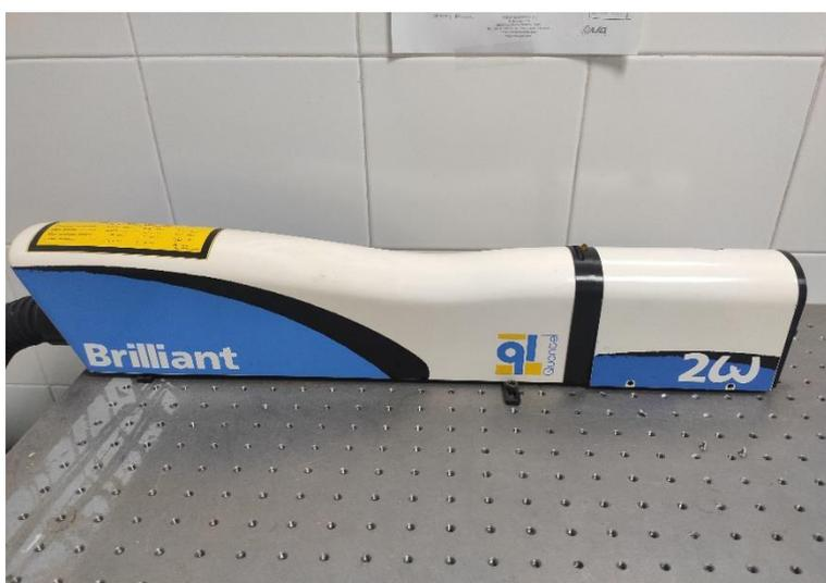
**FIGURA 46.** Fotografía del láser pulsado de 532 nm utilizado durante la ejecución del proyecto.
