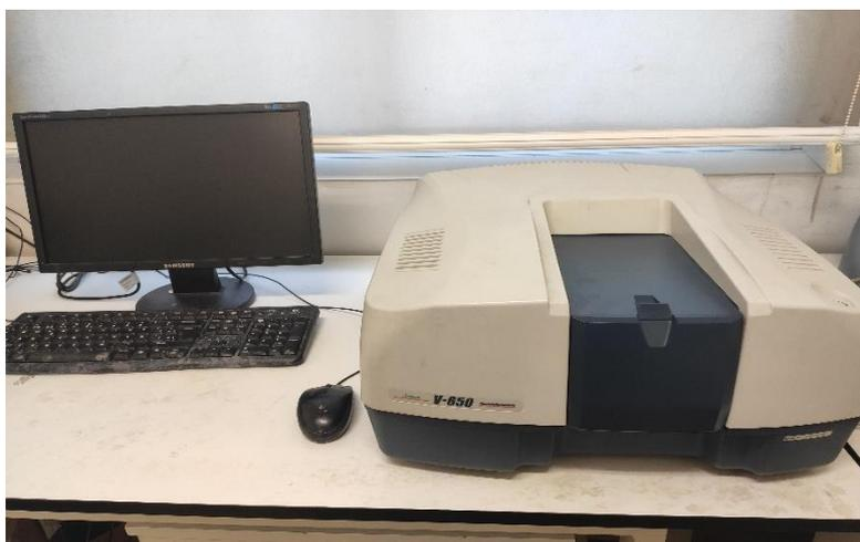
**FIGURA 43.** Fotografía del espectrofotómetro de absorción UV-vis utilizado durante la ejecución del proyecto.
