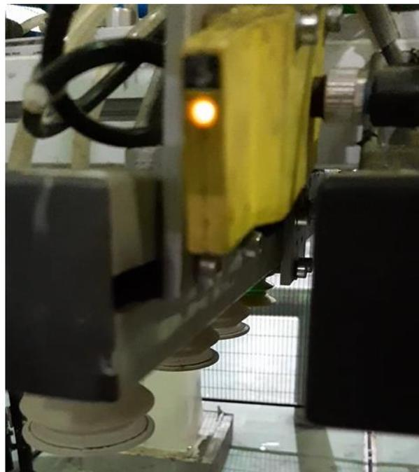
Figura 13. Sensor fotoeléctrico NO detección pallet
