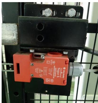
Figura 19. Interruptor seguridad Trojan5
