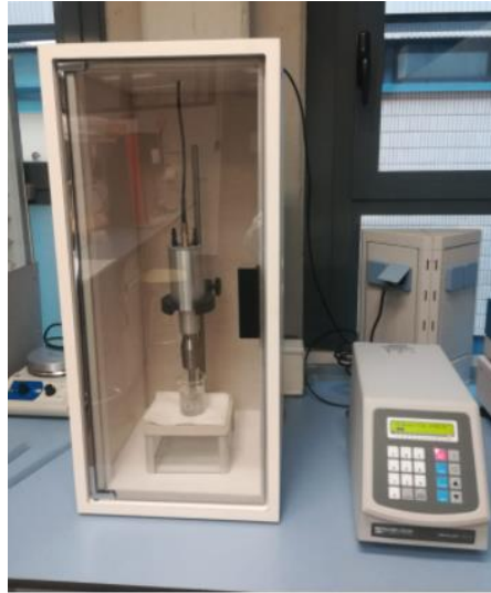
Figura 7. Procesador ultrasónico modelo vibra cell 75115.
