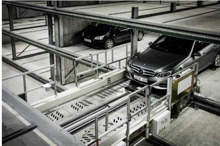
*Ilustración 13. Sistema de transporte de vehículos*
