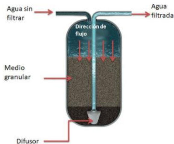
Figura 12. Principi de funcionament del filtre tri-capa. ( https://www.carbotecnia.info/aprendizaje/filtracion-de-agua-liquidos/filtros-industriales-de-agua-tipos-y-aplicaciones/#Filtros_industriales_de_lecho_profundo , 2021).
