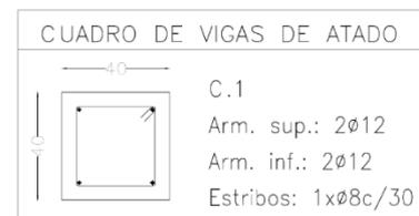
Figura 9. Dimensiones vigas de atado
