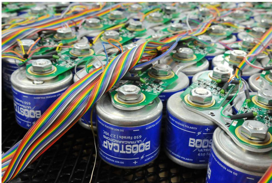
Figura 10. Batería de supercondensadores [23].
