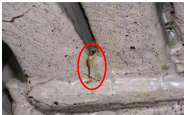
Figura 24. Grieta en un motor eléctrico. [26]
