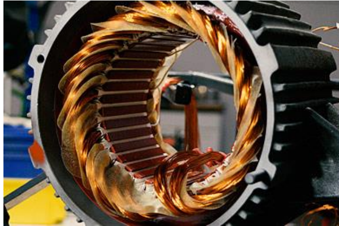
Figura 4. Estator de un motor eléctrico de inducción. [5]
