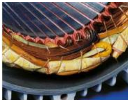
Figura 13. Cortocircuito entre espiras. [17]
