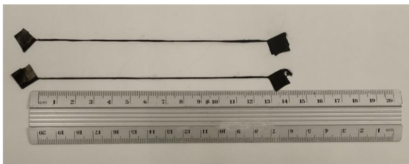
Figura 12. Figuras de PLA recubiertas de PPy (longitud ~14cm).
