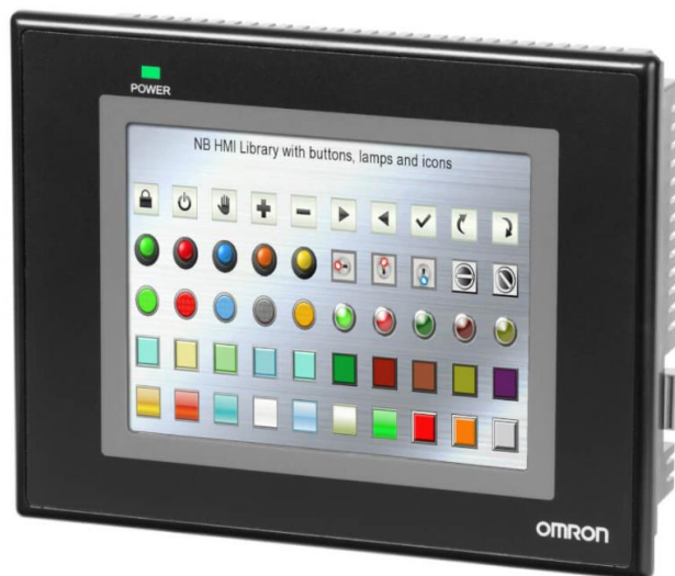
Figura 7. Pantalla táctil HMI NB7W-TW01B
