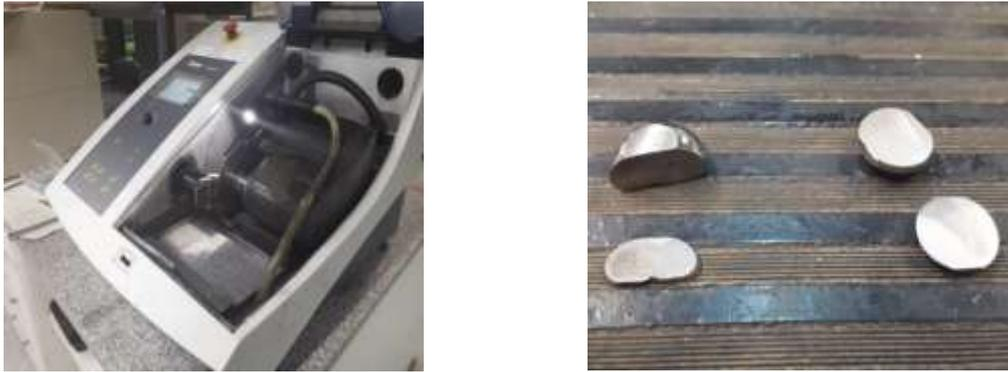
**Figura 5.3.** Imágenes de una cortadora de diamante Struers Accutom10 (imagen izquierda), y de una muestra cortada transversalmente para ensayos mecánicos/microestructurales (imagen derecha, izquierda) y una cortada longitudinalmente para ensayos de corrosión (imagen derecha, derecha).
