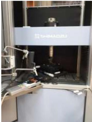
*Figura 4.5. Máquina de ensayos de flexión a voladizo Shimadzu.*
