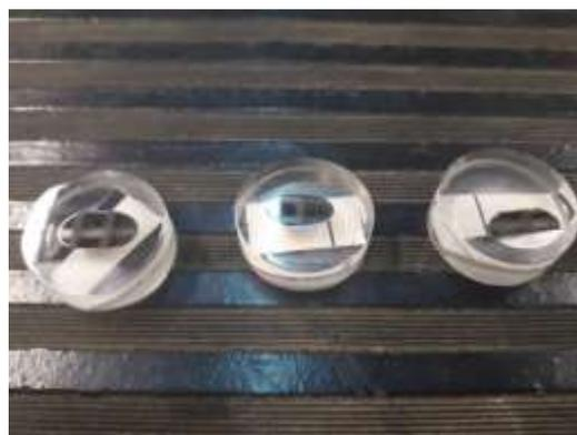
**Figura 5.8.** Muestras de Ti35NbXAg con superficie de pulido espejo.
