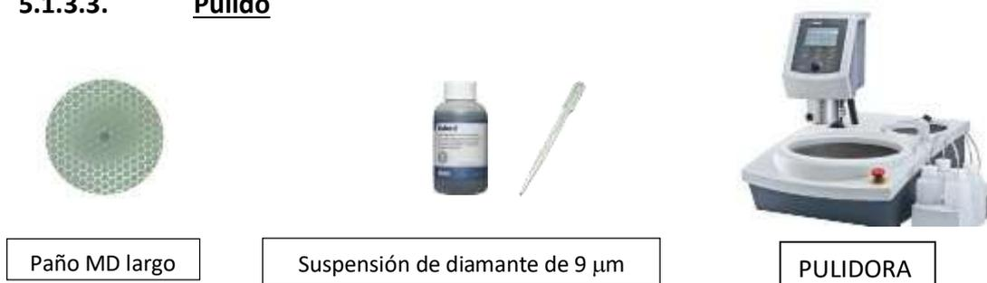
*Figura 5.6. Esquema del proceso del primer pulido [29].*
