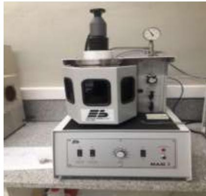
*Figura 5.1. Imagen de horno de fundición por colada Edmund Bühler.*
