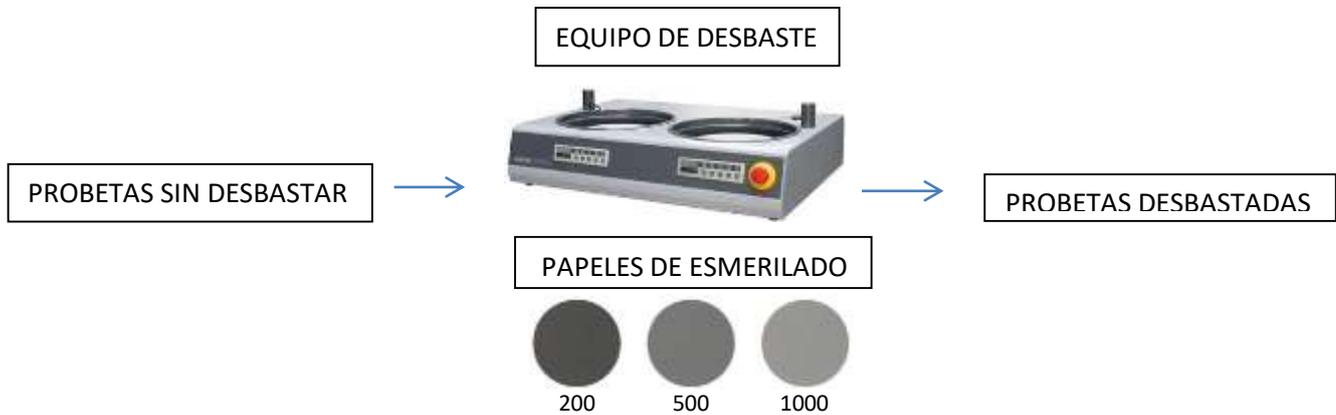
*Figura 5.5. Esquema del proceso de desbastado [29].*
