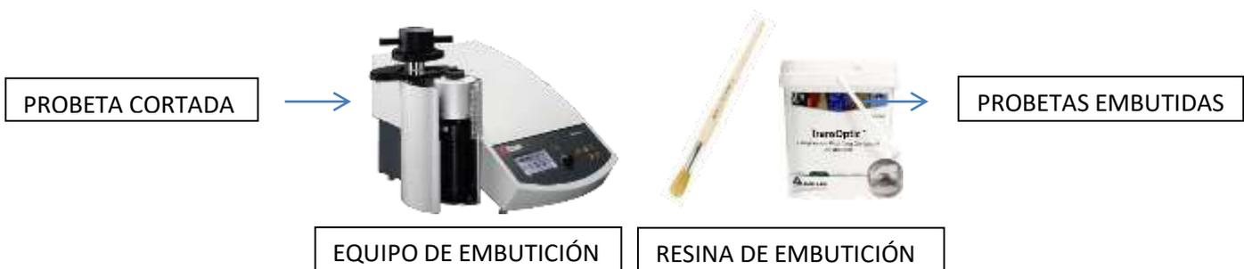
*Figura 5.4. Esquema del proceso de embutición [29].*
