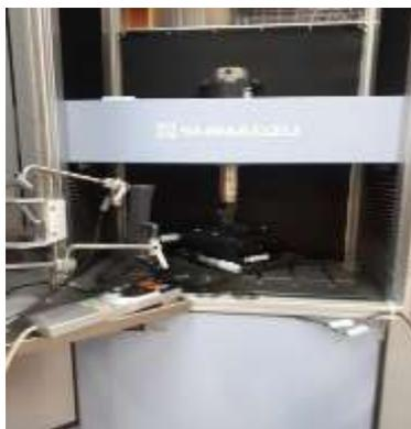
*Figura 5.11. Máquina de ensayos a voladizo Shimadzu.*
