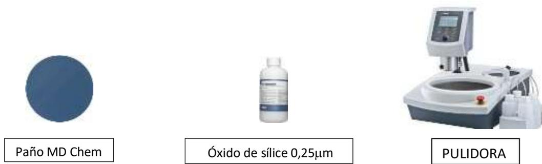
**Figura 5.7.** Esquema del proceso del segundo pulido [29].
