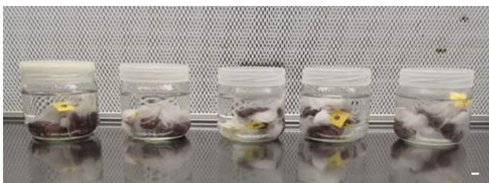
Figura 5. Material necesario para la esterilización del material vegetal en la cabina de flujo laminar. Botes estériles con agua desionizada y las semillas en el interior. La barra representa 1 cm.
