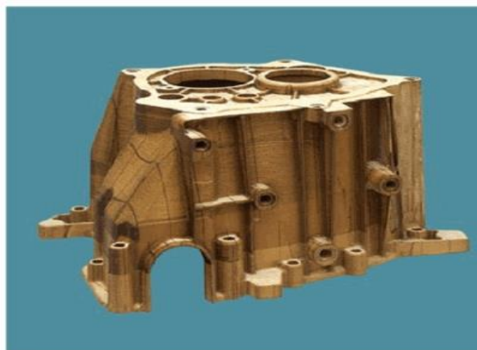
Figura 10. Prototipo realizado con una impresora LOM.
