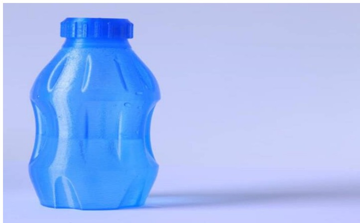
Figura 18. Prototipo realizado con material PETG.
