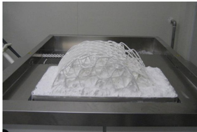
Figura 5. Prototipo realizado con tecnología SLS
