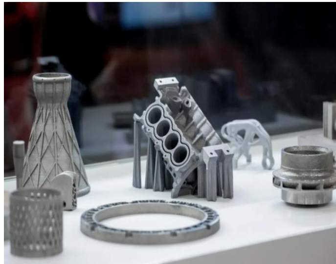
Figura 12. Prototipo realizado con una impresora DMLS.
