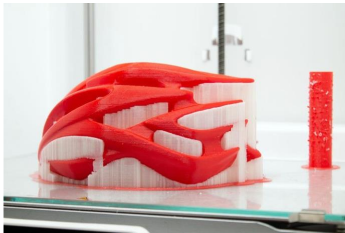
Figura 21. Prototipo realizado con material PVA.
