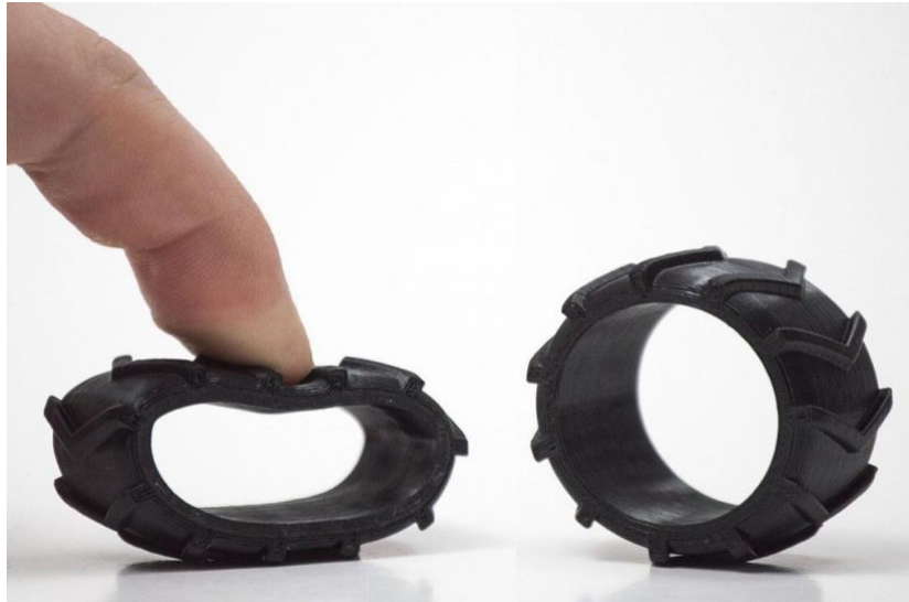
Figura 16. Prototipo realizado con material TPE.
