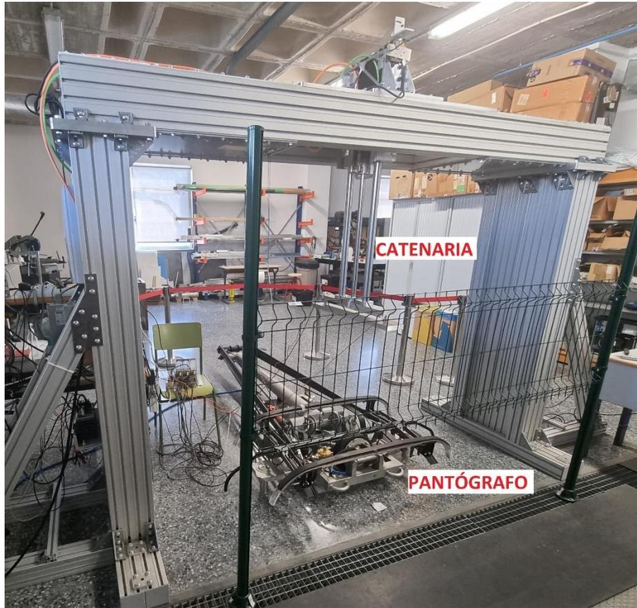
Figura 1: Banco de ensayos de la catenaria virtual.
