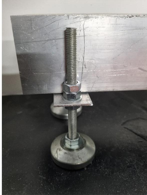
*Figura 41: Tornillo para la regulación en altura del tubo de seguridad.*
