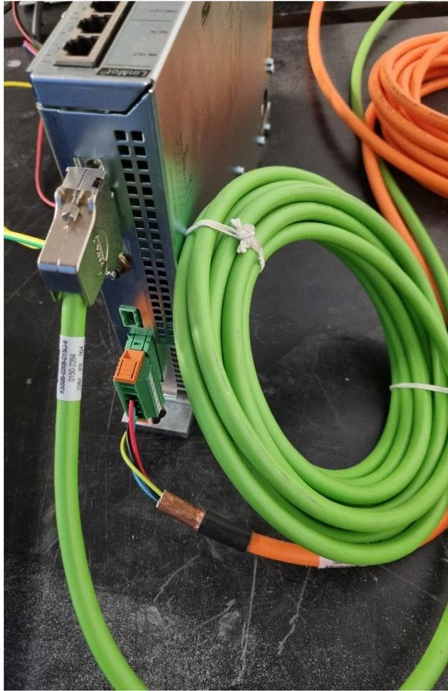
Figura 44: Conexiones de alimentación y control en el lado del controlador.
