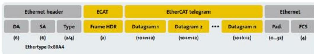
Figura 12: Elementos de un datagrama EtherCAT.
