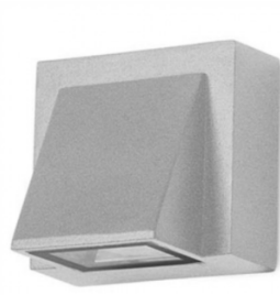
Figura 2.7: Lámpara LED para uso exterior grado de protección IP65, con una potencia de 6W y una potencia luminosa equivalente a 60W y un flujo luminoso de 810 lúmenes.
