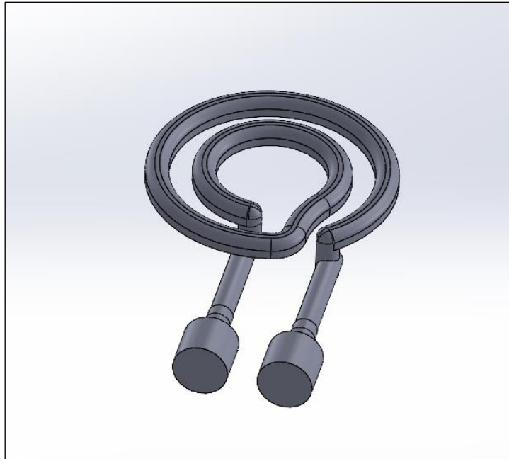
Ilustración 100: Esquema Circuito Refrigeración Lado Fijo
