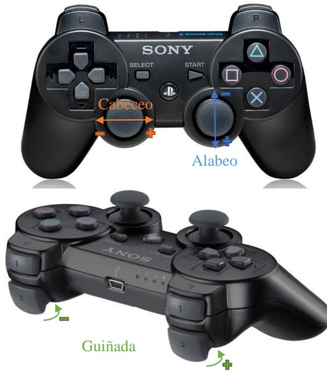
Figura 28: Controles usados del mando
