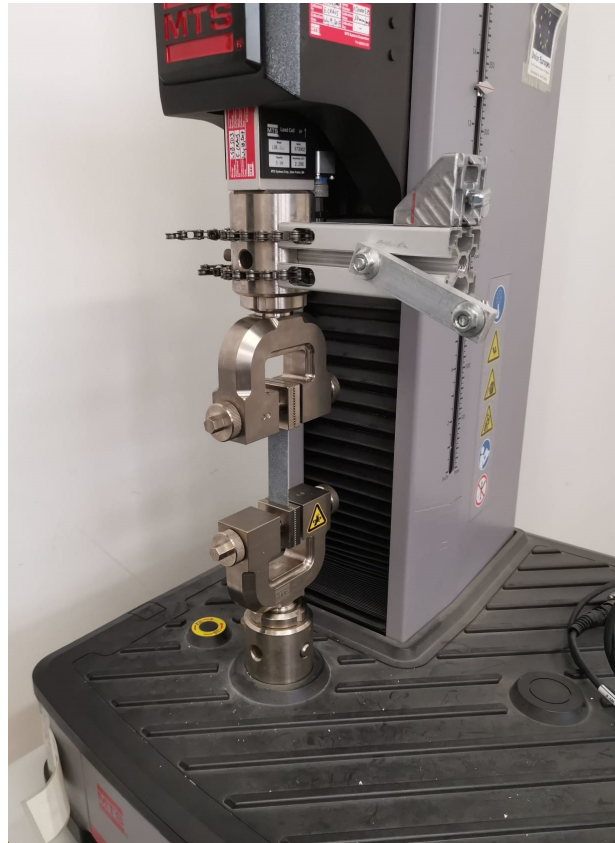
Figura 4.8: Máquina MTS preparada antes del ensayo.
