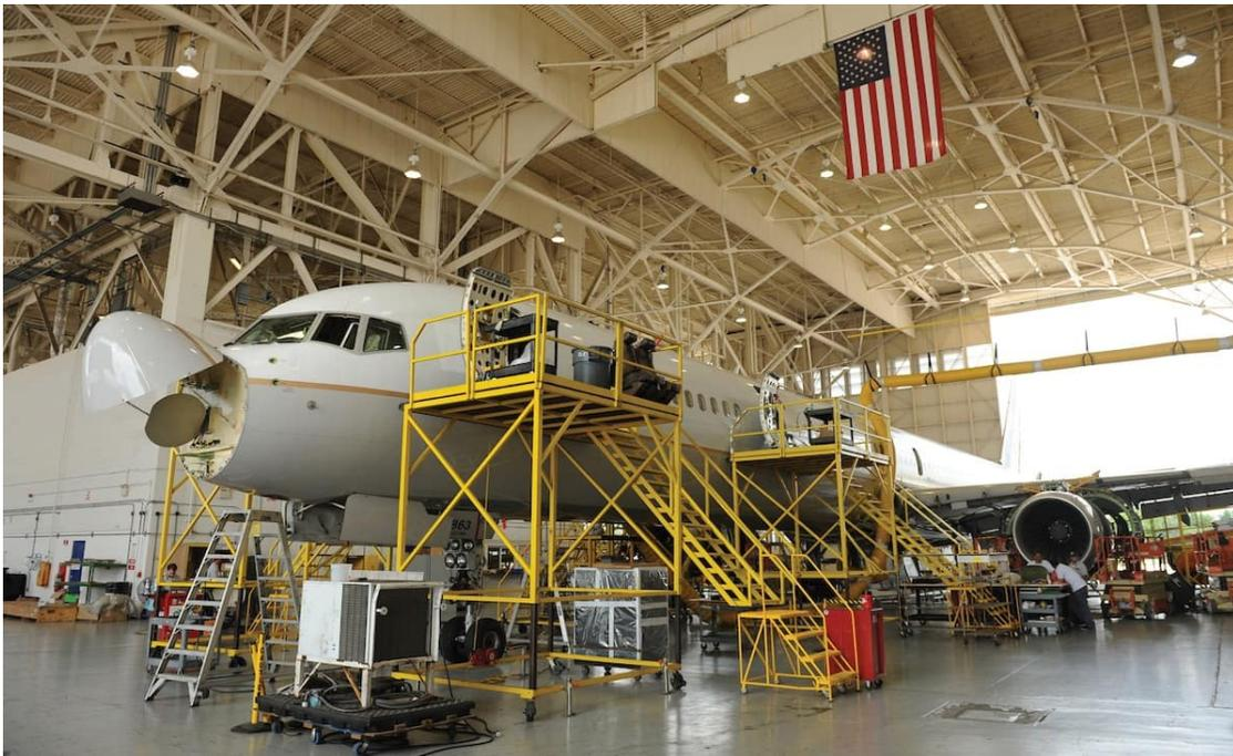
Figura 13: Revisión de mantenimiento tipo C. (26)
