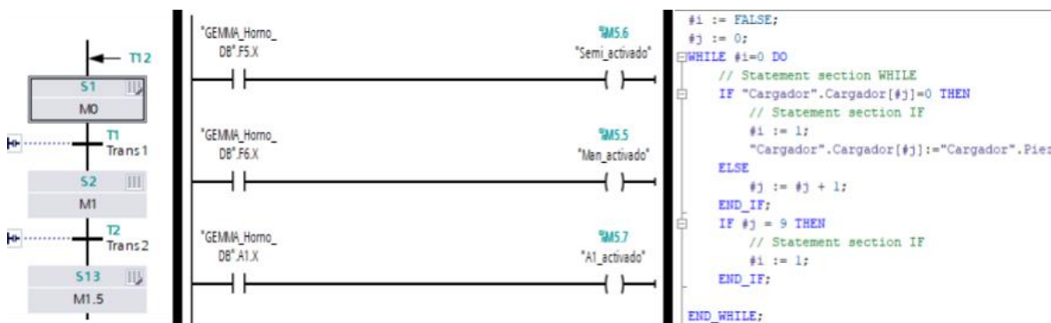
Ilustración 22. Lenguaje graph (izquierda), KOP (centro) y SCL (derecha) (Fuente: Elaboración propia)
