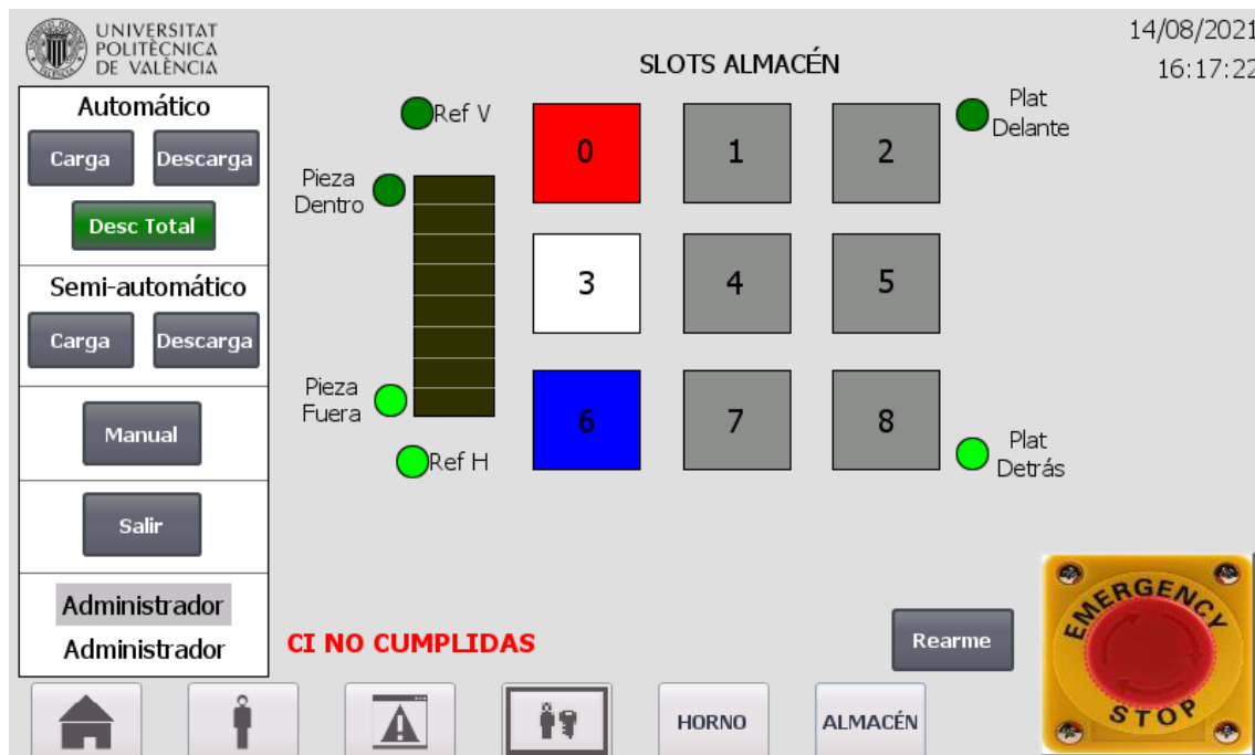
Ilustración 48. Ventana principal del almacén en la pantalla HMI (Fuente: Elaboración propia)
