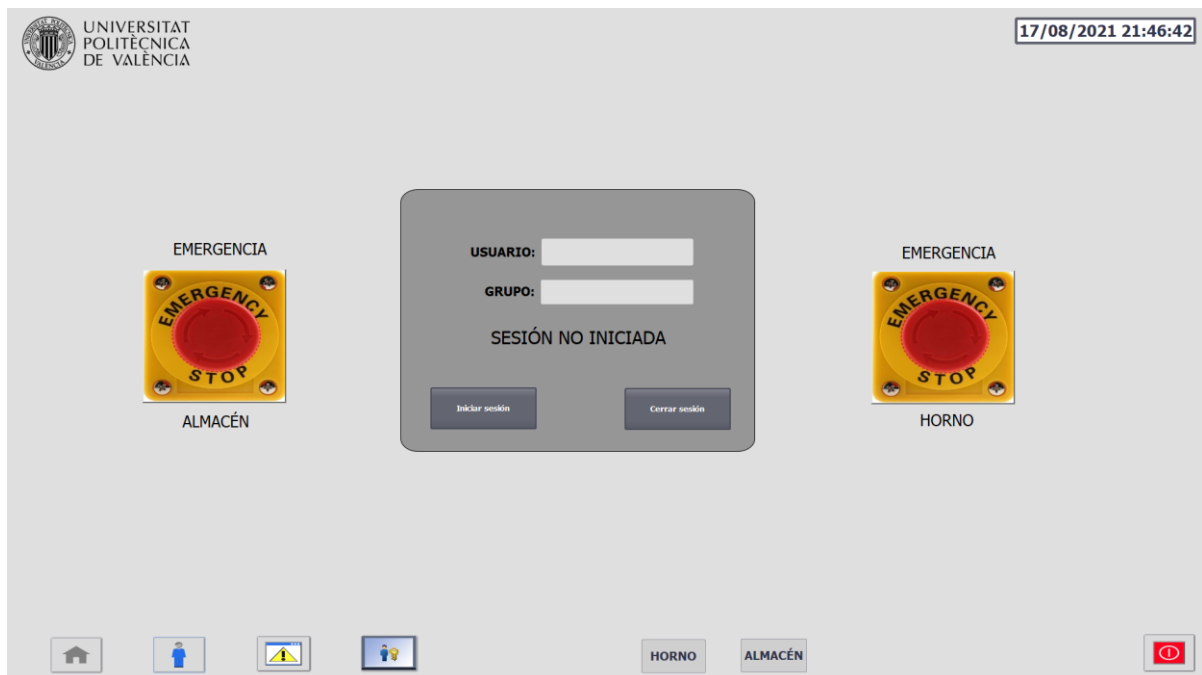
Ilustración 51. Ventana de inicio de sesión de la aplicación SCADA (Fuente: Elaboración propia)
