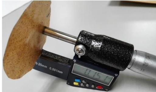
**Figura 9.** Medida del espesor de los círculos de film para el ensayo de permeabilidad.
