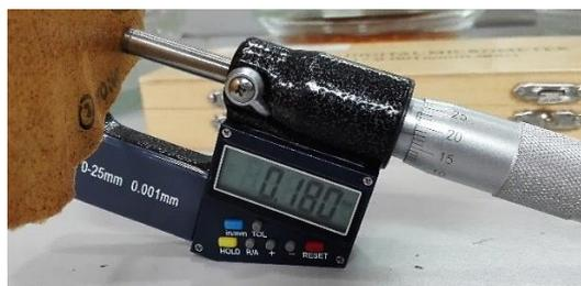
**Figura 5.** Medida de espesor de los films con el micrómetro digital
