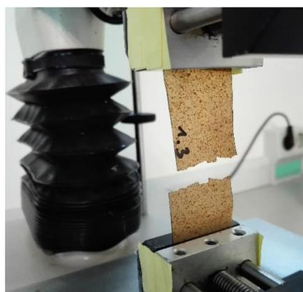
**Figura 7.** Izquierda: analizador de textura; derecha: punto de ruptura del film en el ensayo de mecánicas.
