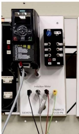
Figura 7.1a. Conexión mediante variador.
