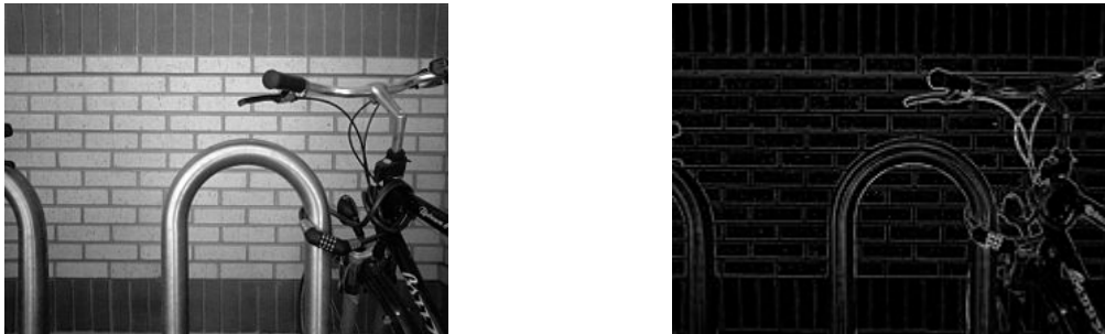
Figura 24. Operador de Sobel y aplicación a una imagen para la detección de bordes [16]
