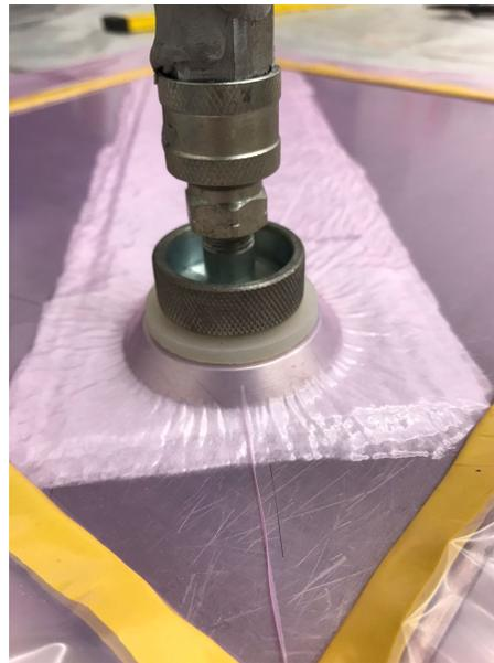
Figura 68: Vacío generado por la bomba.
