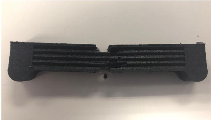
Figura 53: Probeta ensayada núcleo EVANS 2D y espesor alar 1 mm.
