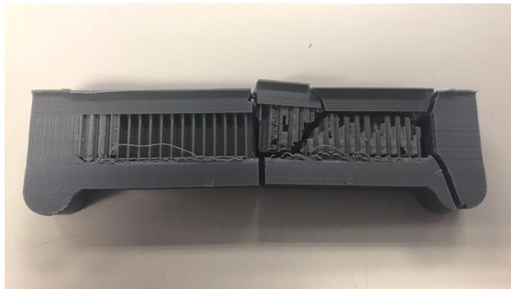
Figura 63: Probeta ensayada núcleo de panal de abeja y espesor alas 5 mm.
