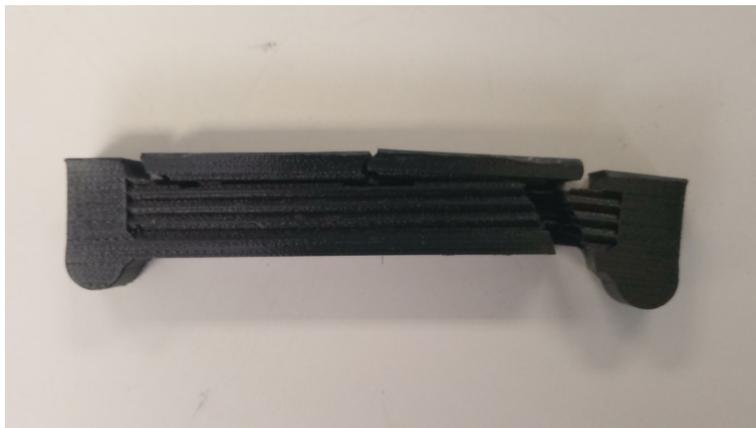
Figura 54: Probeta ensayada núcleo EVANS 2D y espesor alar 3 mm.
