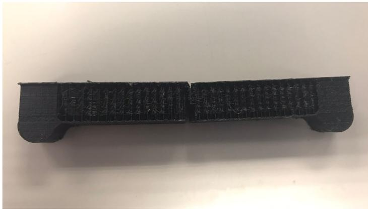
Figura 59: Probeta ensayada núcleo de panal de abeja y espesor alas 0.5 mm.
