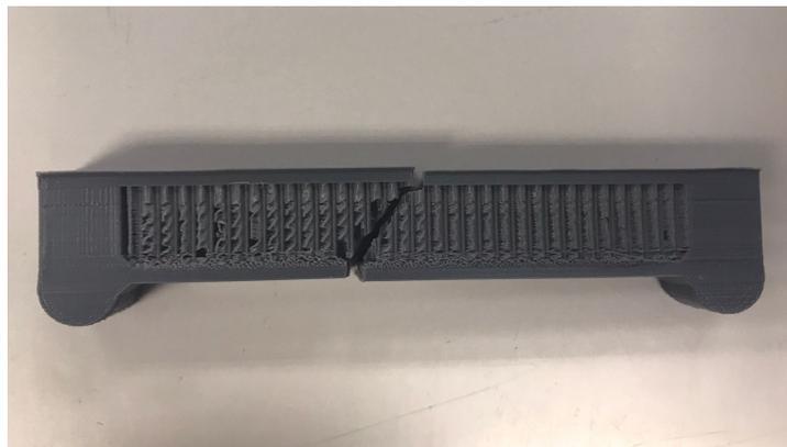
Figura 60: Probeta ensayada núcleo de panal de abeja y espesor alas 2 mm.
