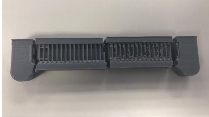
Figura 61: Probeta ensayada núcleo de panal de abeja y espesor alas 3 mm.
