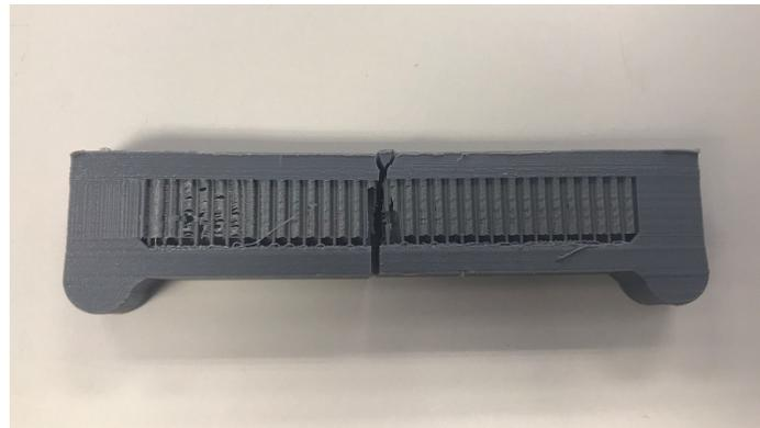
Figura 62: Probeta ensayada núcleo de panal de abeja y espesor alas 4 mm.
