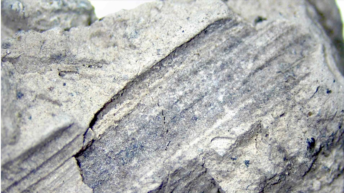
Fig. 129: Detalle de improntas vegetales en argamasa-base de QT1 fotografiado con lupa a 8x.
