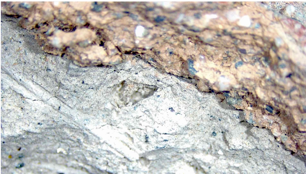
Fig. 110: Detalle de la superposición de estratos y del acabado más rojo (en la parte superior derecha de la imagen). Imagen tomada con lupa de 8 x
