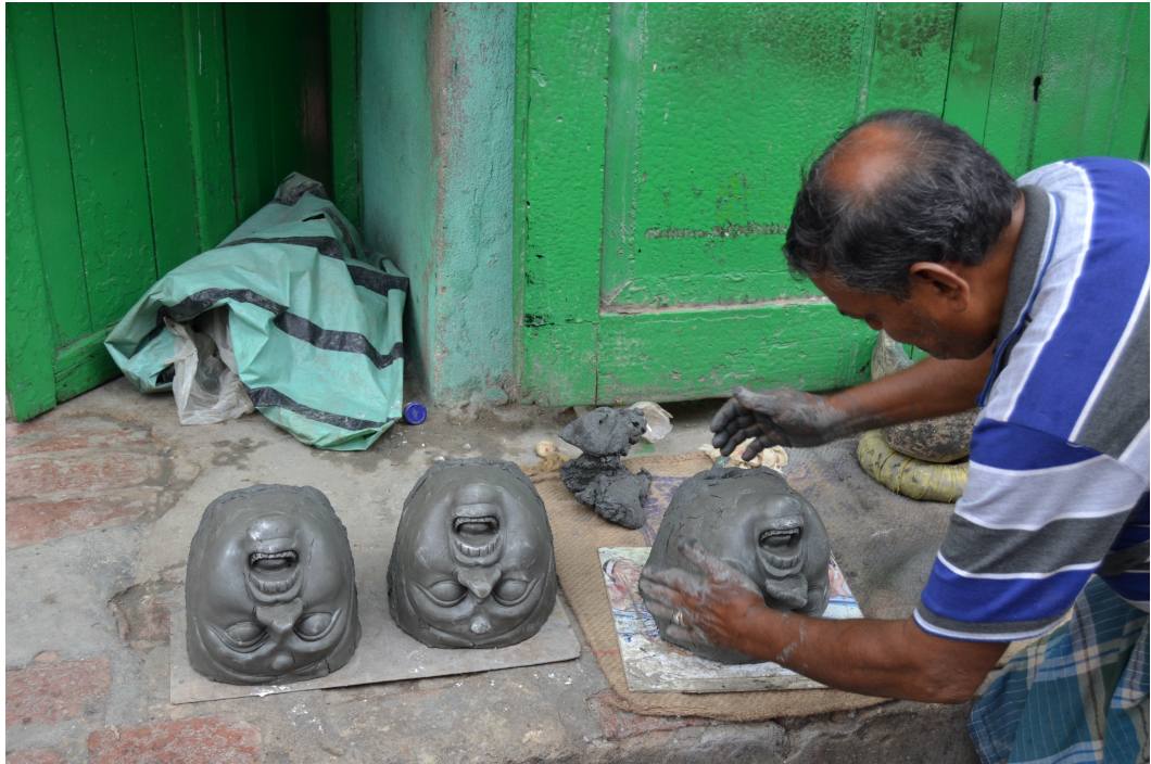
Fig. 79: Una vez finalizado el moldeado de la cabeza, sin dejar que se seque sobre el molde se vuelca sobre una superficie plana manejable y se deja secar
