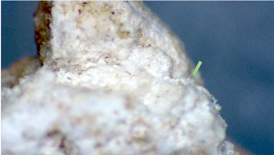
Fig. 132: Detalle del tejido dispuesto entre las capas de estuco tomada con lupa 8x
