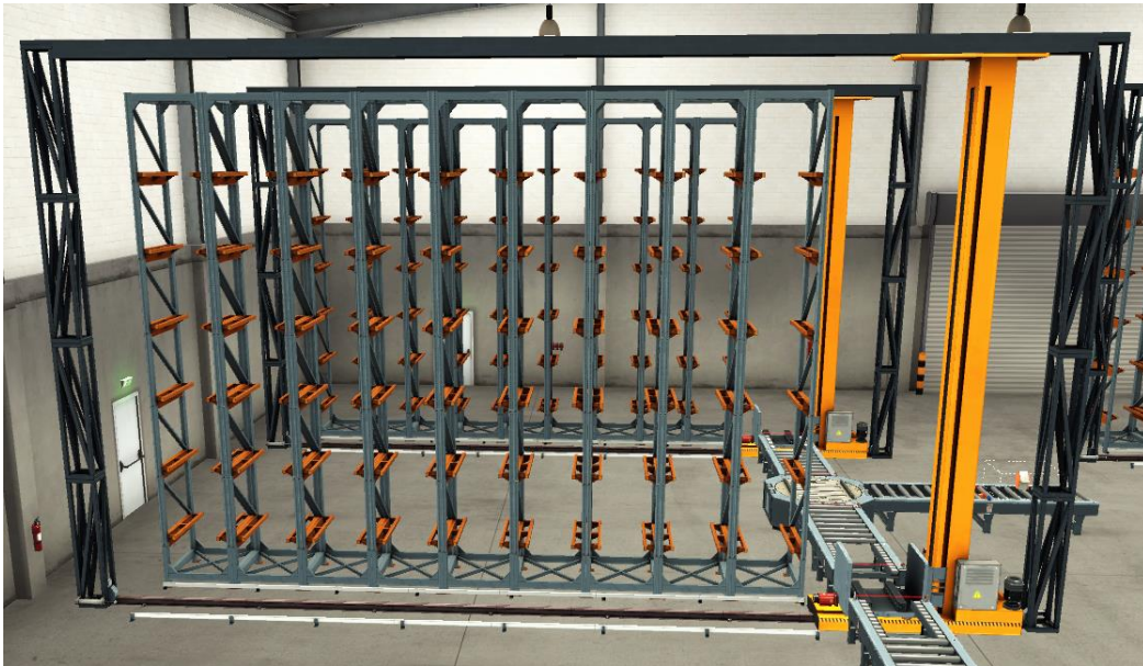
Figura 2. 17. Transelevador y estantería de Factory I/O .
