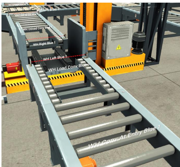
Figura Anexo 24. Actuadores Zona 6 (2) de Factory I/O.
