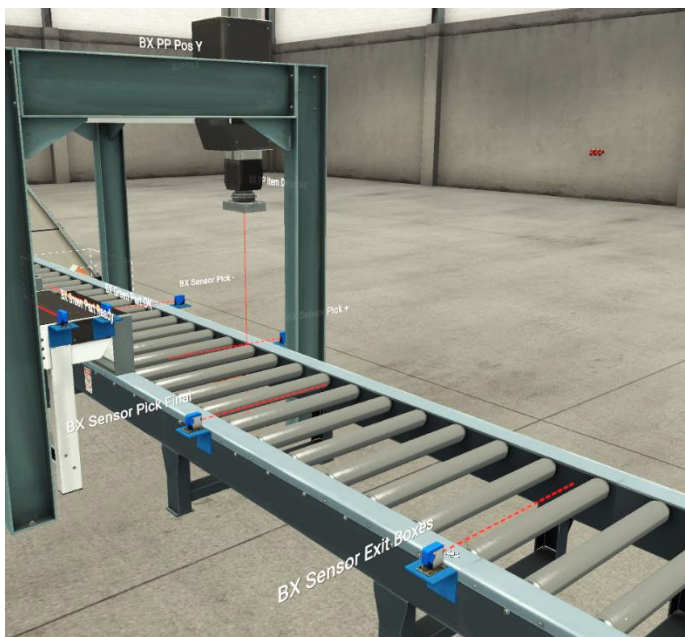
Figura Anexo 7. Sensores Zona 5 (3) de Factory I/O.
