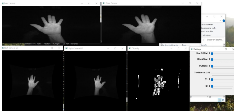
Figura 5.13: Entorno de pruebas para la creación del mapa de disparidad.
