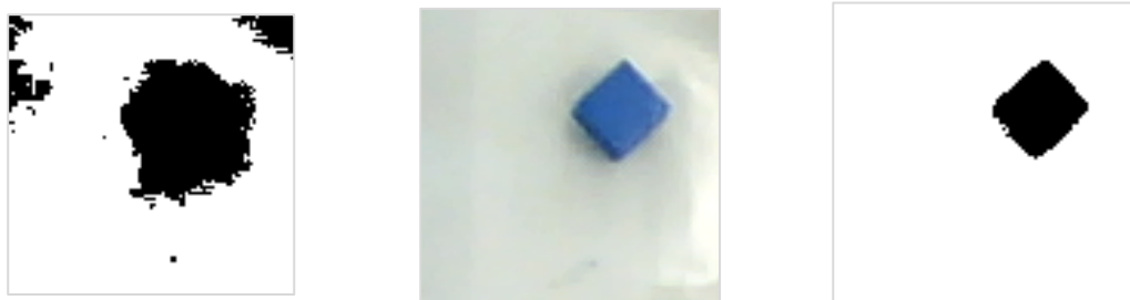
Figura 61. Mejora en la detección color aplicando escala HSV
