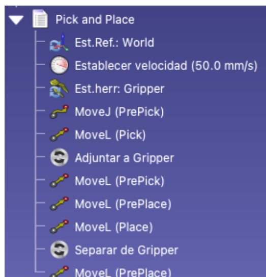
Figura 36. Programa pick & place Ejemplo Post-Procesadores.
