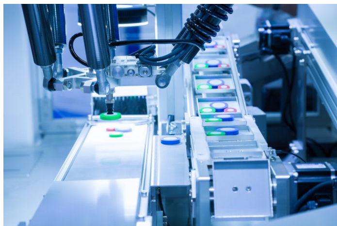
Figura 7. Brazo robótico con sistema de visión artificial integrado. (Fuente: Electrónica Edimar)
