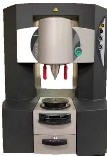
Figura 5. Reómetro rotacional de estrés controlado.
