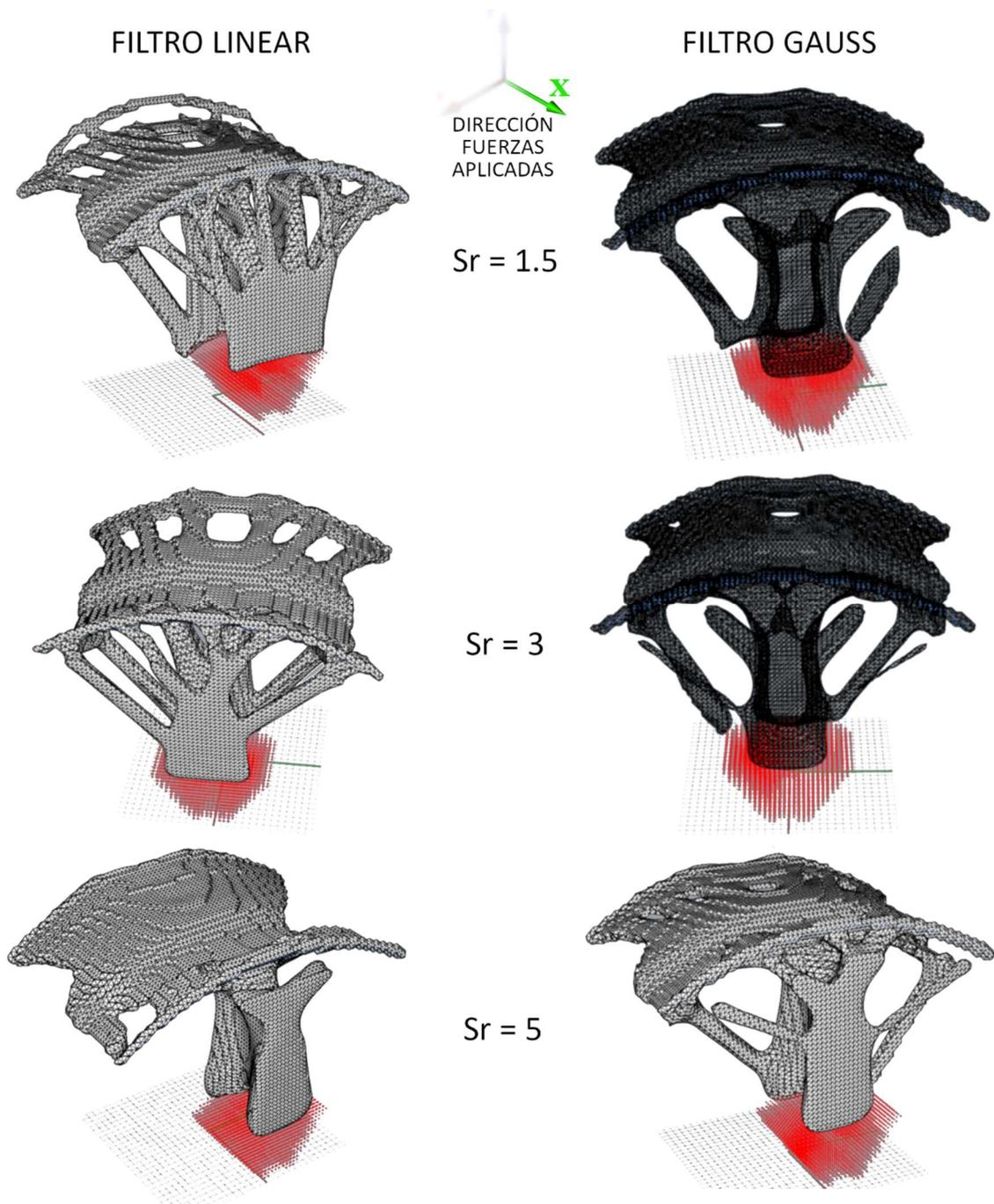
Figura 49 Resultados de la optimización de la llanta en Grasshopper para distintos  $Sr$  en dos tipos de filtro, fuerzas aplicadas en eje  $x$
