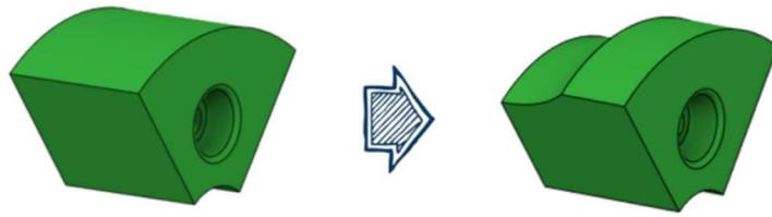
Figura 45 Detalle del cambio de geometría de la llanta
